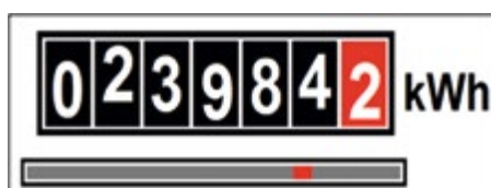
Abbildung 2: Zählerstandsanzeige bei herkömmlichem Ferrariszähler
