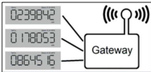
Abbildung 4: Beispielhaftes intelligentes Messsystem bestehend aus drei Basiszählern und einem Gateway.
