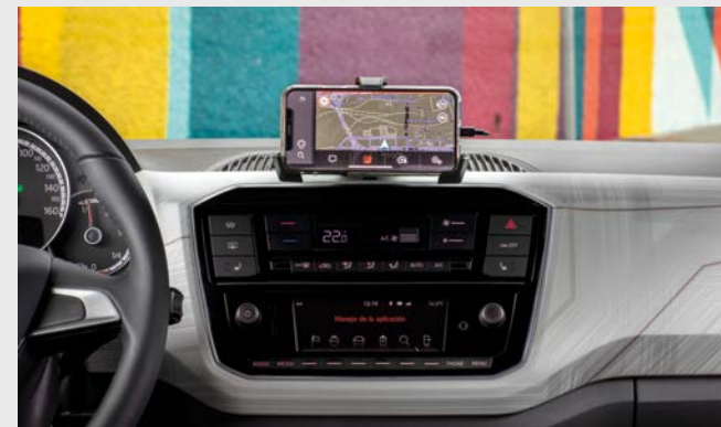
Ein Navi ist nach wie vor nicht an Bord. Stattdessen befindet sich über der Bedieninsel eine Universalhalterung für das Smartphone mit einem Luftausströmer für die Kühlung des Akkus dahinter.
