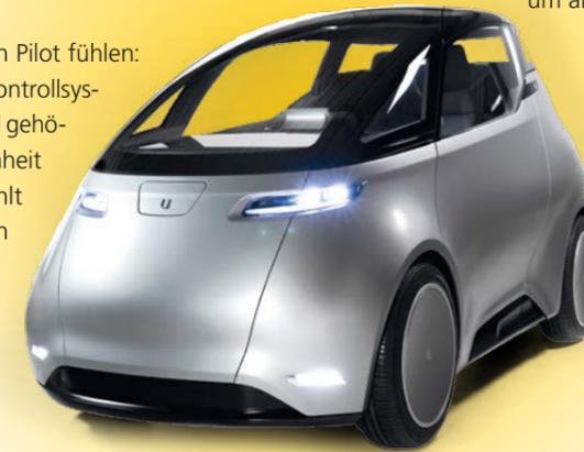
funktioniert über ein Tablet am Steuerruder. Der Akku reicht mit einer Kapazität von 22 kWh für rund 300 km. Nach drei Stunden an der heimischen Steckdose ist die Batterie wieder komplett aufgeladen. Im Schnell-Lademodus reicht sogar eine halbe Stunde, um anschließend 200 km fahren zu können.
