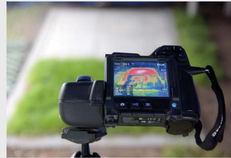
Der Abwasserbetrieb Troisdorf, AöR (ABT) hat beim diesjährigen Energietag mithilfe einer Infrarotkamera eindrucksvoll vor Augen geführt, wie unterschiedlich die Wärmeabstrahlung von begrünten und versiegelten Flächen ist.
