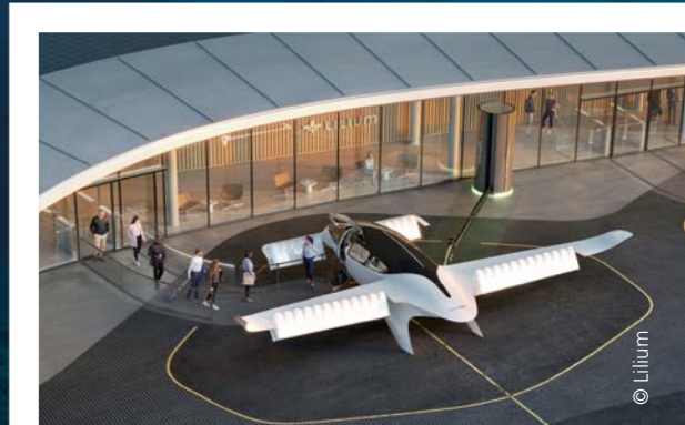
Weil sie senkrecht abheben wie Hubschrauber, benötigen Flugtaxis zum Starten und Landen nur wenig Fläche.
