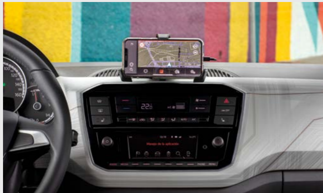
Ein Navi ist nach wie vor nicht an Bord. Stattdessen befindet sich über der Bedieninsel eine Universalhalterung für das Smartphone mit einem Luftausströmer für die Kühlung des Akkus dahinter.
