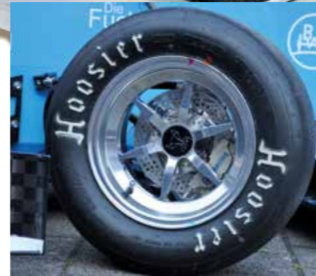
An jedem Rad befindet sich ein Nabenmotor. Den Allradantrieb gab es auch schon bei Betty.
